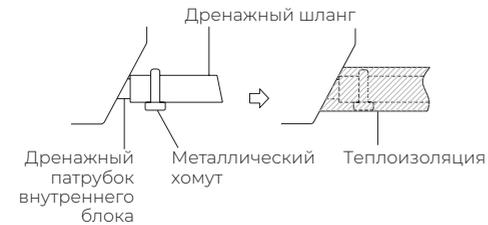
Установка блока без встроенной дренажной помпы
