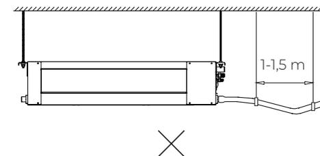
При прокладке дренажного трубопровода, не допускайте образования
