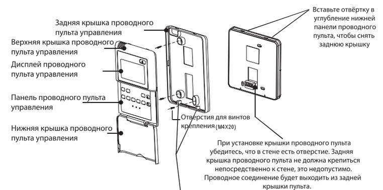
При установке проводного пульта необходимо отрегулировать нижнюю часть его панели относительно задней крышки, которую сначала нужно закрепить и только потом вставить другой конец панели проводного пульта.
