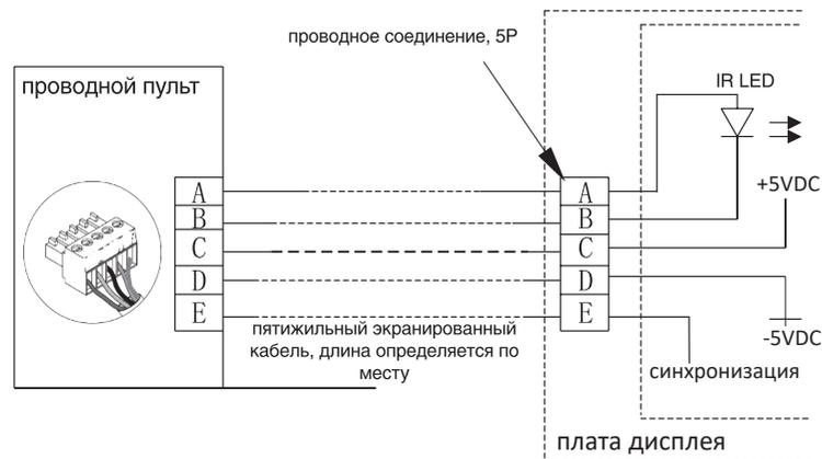
**Пояснение по монтажу:** при подключении проводного пульта используется кабель 5×0,5 мм<sup>2</sup>, без экрана. Максимальная длина кабеля не более 20 метров. Кабель подключается к модулю с одной стороны, с другой стороны к пульту.
